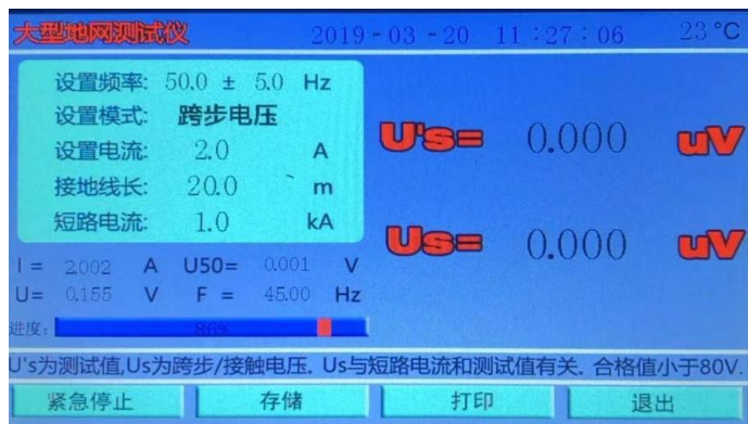
(图 19) 跨步电压测试界面
