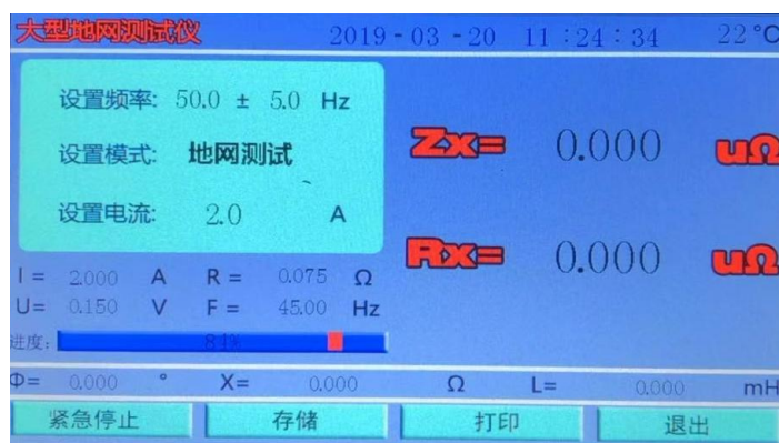
图 11 地网测试界面
